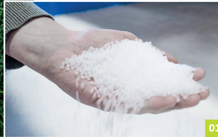
01 Rezyklat aus PP und TPE dient als Ausgangsmaterial für die Rollen der ECO-Serie
